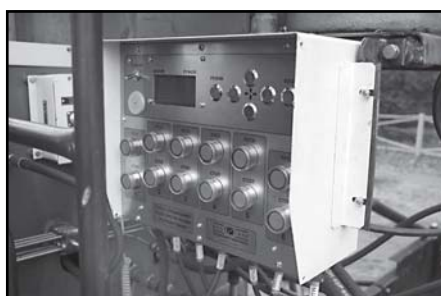
Рис. 4. Пульт управления системой газового обогрева рабочей плиты асфальтоукладчика
