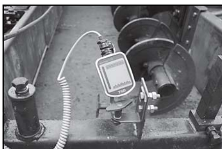
Рис. 3. Ультразвуковой датчик TSD контроля заполнения АБС шнековой камеры
