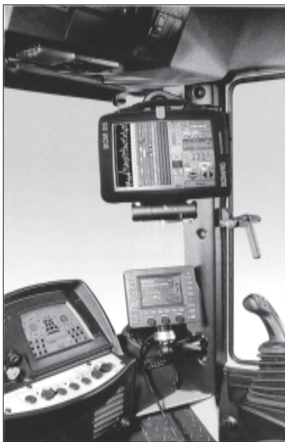
Рис. 1. Каток BW213-4 BVC фирмы Bomag, на котором установлена фирменная система автоматизированного управления вибрационным усилием VarioControl (система IC) для грунтовых машин: в центре — основной пульт управления машиной; внизу справа — панель управления системой IC;верху справа — система документирования Bomag
